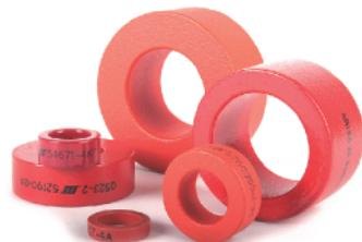
美磁绕带磁芯是由高磁导率的镍铁(80%或50%镍)和硅铁合金制成。这些合金就是我们熟知的Orthonol®、Permalloy80、镍铁钼超导磁合金、48合金、以及Magnesil®。绕带磁芯有数百种尺寸可供选择，最小外径为0.438英寸(1.11mm)，最大外径可达9英寸(22.86mm)上。各种材料的生产厚度介于1/2mil(0.013mm)到4mil(0.102mm)之间，可使用于不同的频率应用。磁芯外覆坚固的尼龙或铝外壳，标称连续工作温度为200°C，最小击穿电压高达2000V。
